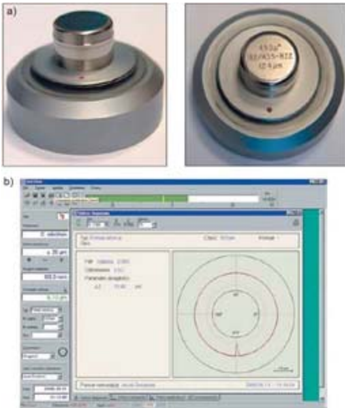
Rys. 11.2. Wzorzec okrągłości: a) widok ogólny, b) profilogram zarysu
